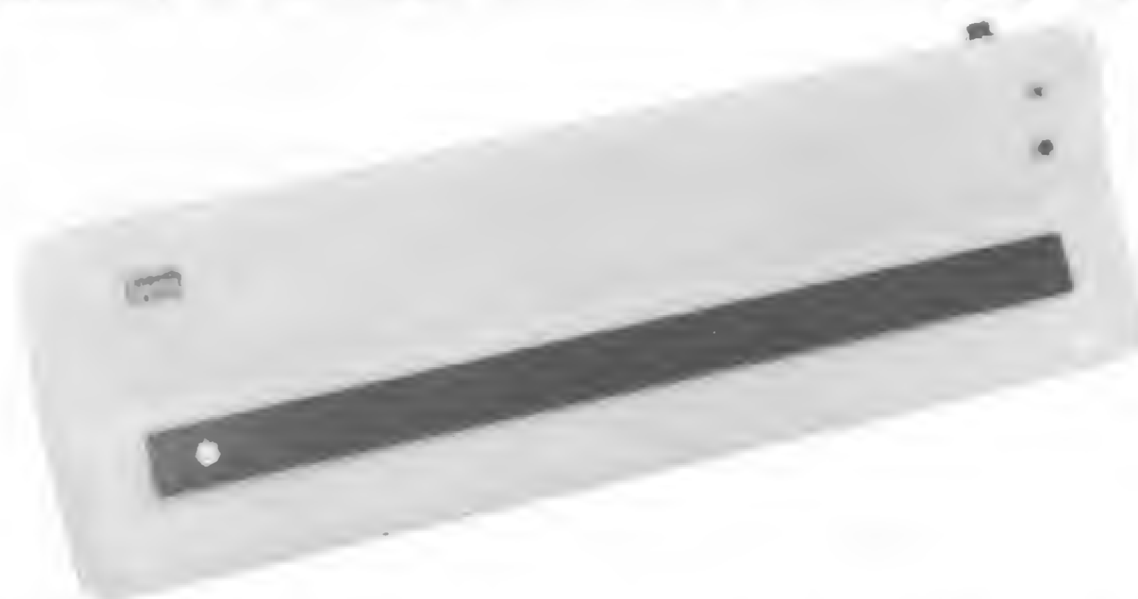
Apagador de EPROMs – submete esses dispositivos a um banho de luz ultravioleta durante 15 minutos, fazendo com que as informações gravadas anteriormente sejam eliminadas.
